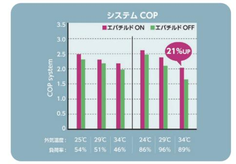
エバチルドの運転時と停止時における性能評価を行った結果、夏季ピーク時の運転に近い外気温度34℃、負荷率89%で、エバチルド運転によりサイクルCOPで25%、エバチルドの動力を加えたシステムCOPで21%の性能向上が確認できました。
