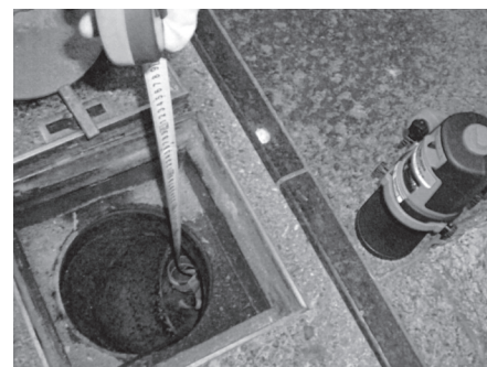
写真2 レーザー水平器とコンベックスによる管底深さ調査
