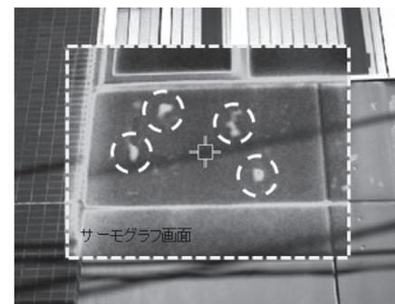
写真5 コンクリート壁の表層の浮き状況(上)と
